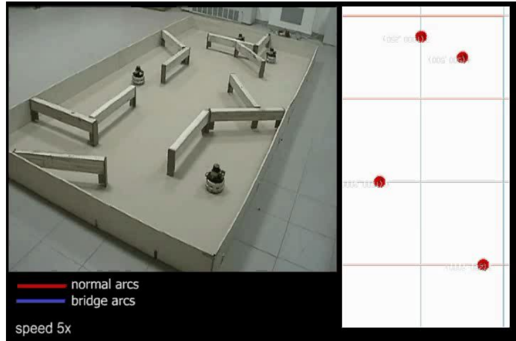
team di robot Khepera (controllo decentralizzato e range limitato di comunicazione)
